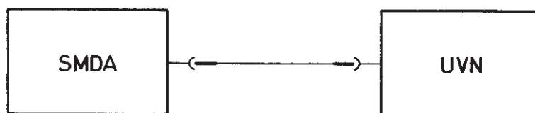
Bild 3-8 Messen der Ausgangsspannung des Modulationsgenerators
